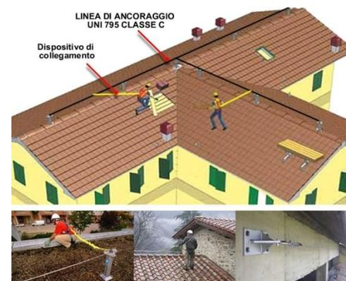
I dispositivi di ancoraggio conforme alle norme UNI EN 795 in classe C utilizzano linee di ancoraggio flessibili orizzontali realizzate con fune metallica, fissata a due o più elementi di ancoraggio installati in modo permanente ad una struttura.
