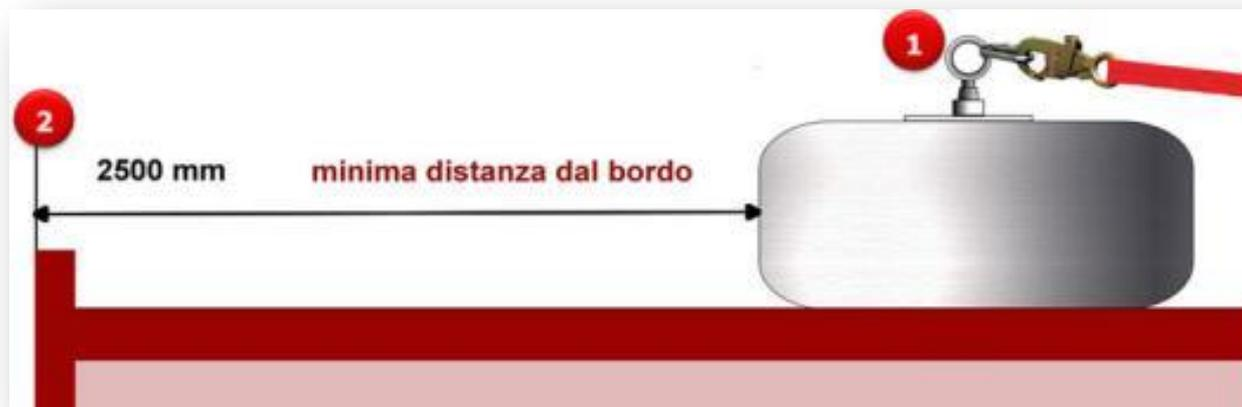
Limite di distanza dal bordo per dispositivi di ancoraggio a corpo morto
